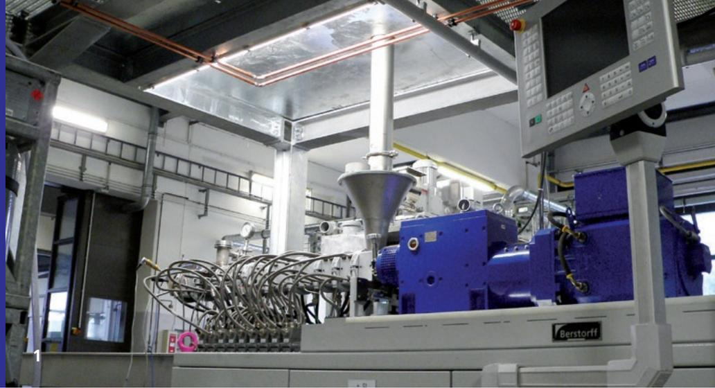
1 Kleiner Techniksextruder zur Herstellung von Mustermengen bis zu 60 kg/h.
